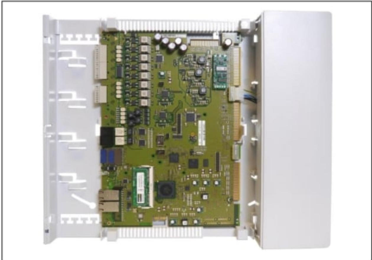
Das Netzteil (PSU) ist in das rechte Gehäuse integriert. Bei Netzspannungsbetrieb sind keine weiteren Komponenten notwendig.
