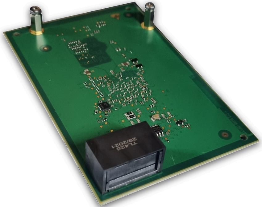
**Abbildung 12: Beispiel OCCBL - Rückseite mit gesteckten Abstandsbolzen**
